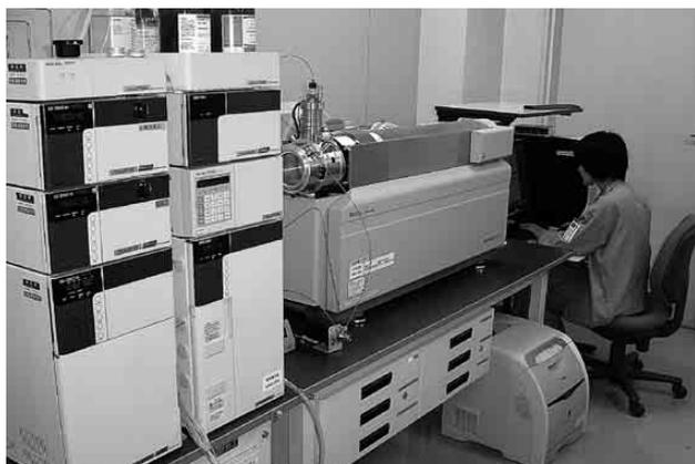
図4 液体クロマトグラフトンデム質量分析計 (LC/MS/MS)
