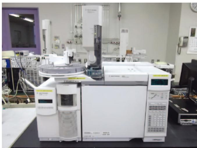
図2 ガスクロマトグラフ質量分析計 (GC/MS)
