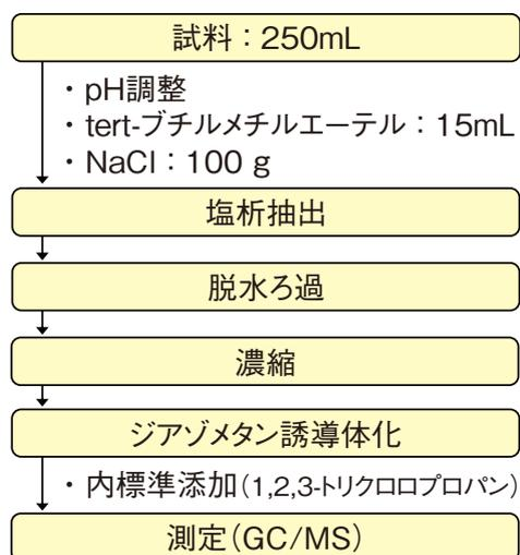
図1 ハロ酢酸類の前処理フロー
