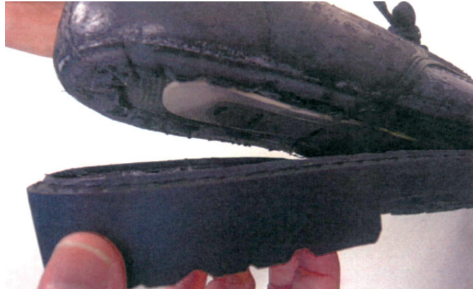
写真1 ポリウレタン系接着剤靴底剥離状況（未使用品）
