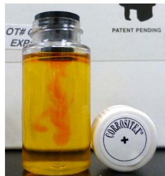
被験物質が膜を透過し 検出試薬が変色する時間を測定
