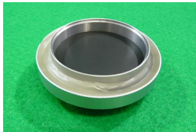
図 2 パラフィンで試験片を封ろうした状態
