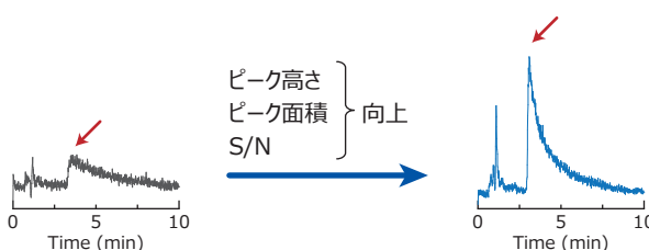
Fig.3 カラムハードウェアの材質比較(クロマトグラフィー管)
