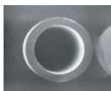
G-column 断面SEM写真と構造
