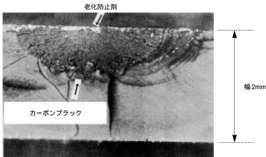
写真1 NBR製JIS3号ダンベルの断面に存在するカーボンブラックの固まりと老化防止剤の固まり（分散不良）
