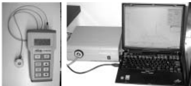
左はUVA照射量の測定装置、右はスペクトルラジオメータ
