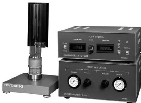
酸素指数測定装置（キャンドル式燃焼試験機）
