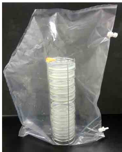
図1 密閉バッグを用いた被験物質ガスの暴露 菌を接種した培養プレートをホルダに設置し、 バッグ内で被験物質ガスに暴露します
