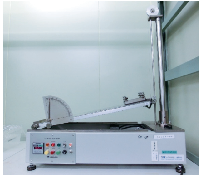
図5 摩擦係数測定装置（傾斜法）
