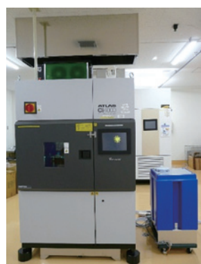
過酸化水素水噴霧システム搭載キセノンウェザーメータ
