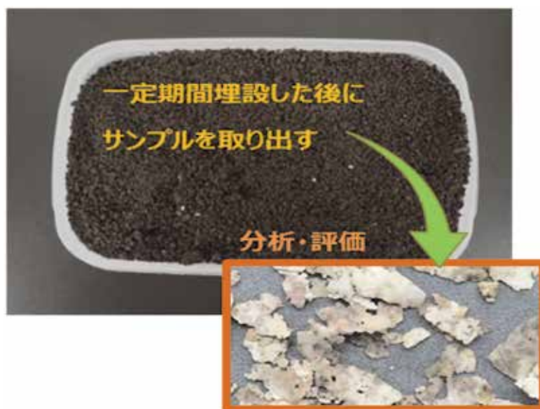
図2 実験室規模での土壌埋設による試験
