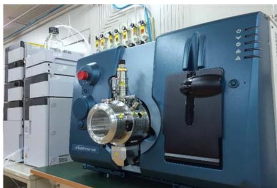
図1 LC-MS/MS 装置の写真
