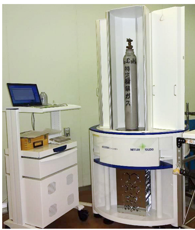
図1 標準分銅校正用大型マスコンパレータ AX32004 (METTLER TOLEDO 社製)
