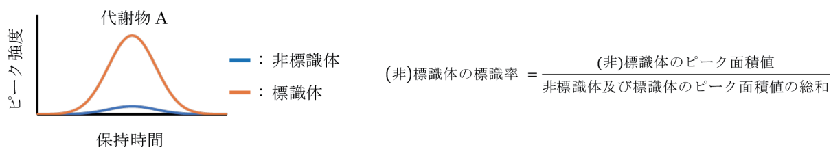
図2 質量分析計で得られるデータ及び標識率導出の計算式
