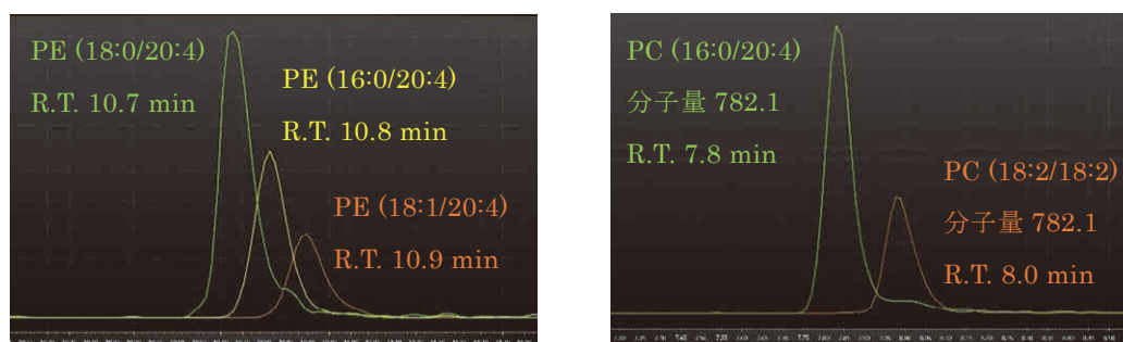
図1 ホスファチジルエタノールアミン (PE) 及びホスファチジルコリン (PC) の超臨界流体クロマトグラフ-質量分析計クロマトグラム
