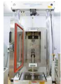
図6 疲労試験機 サーボパルサー外観
