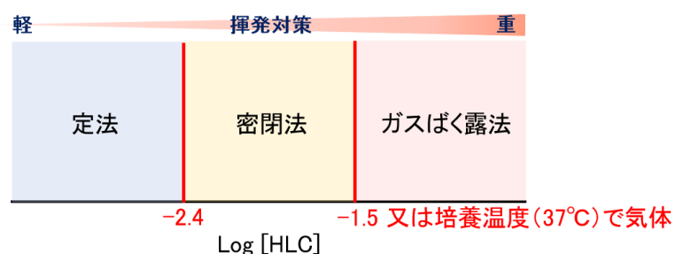
図 4 ヘンリー一定数を用いる揮発性化学物質のための Ames 試験法選択基準
