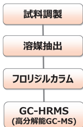
図 6 デクロランプラス分析フロー例
