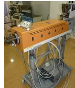
東洋精機製二軸押出試験機
