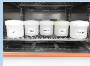
耐薬品性試験状況
