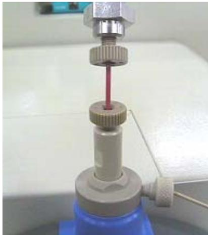
※スプレーヤーに高電圧を印加するタイプの装置では、感電の恐れがあるため、金属の配管は使用しない。
