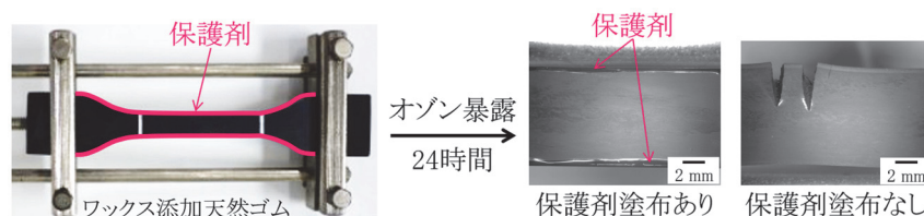
図 5 保護剤を塗布する箇所及び保護剤塗布の有無によるクラック発生状態の違い
